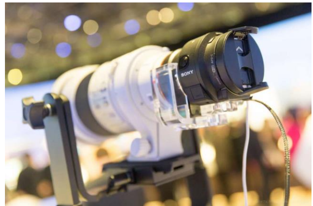
Le Sony QX1 est un adaptateur pour objectif doté d'un capteur CMOS APS-C qui est relié en Wi-Fi au smartphone de l'utilisateur.
