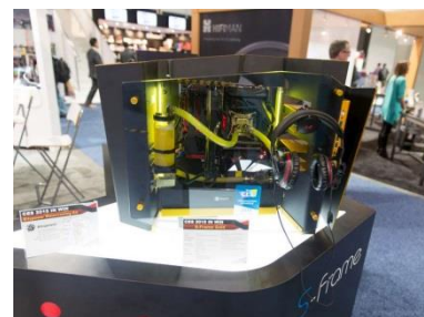
S-Frame Gold de chez Lian-Li aussi avec une façade transparente. L'ordinateur est ouvert, la ventilation étant assurée par refroidissement liquide.
