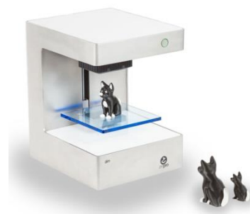
La ZeePro Zim a une résolution de 50 microns, une double tête et est Wi-Fi. Bien pour $700. La société est française mais le cache sur son site ! Elle est aussi passée par Kickstarter.
