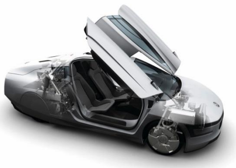
La Volkswagen VW XL1 est un prototype de voiture hybride avec 50 km d'autonomie en motorisation électrique. Elle consommerait 0,9 L aux 100 km.
