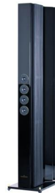
Les autrichiennes Broadmann JB205 intègrent 10 HP : 2 basses, 4 médium et 4 tweeters pour une puissance maximale de 480W sous 4 Ohms.
