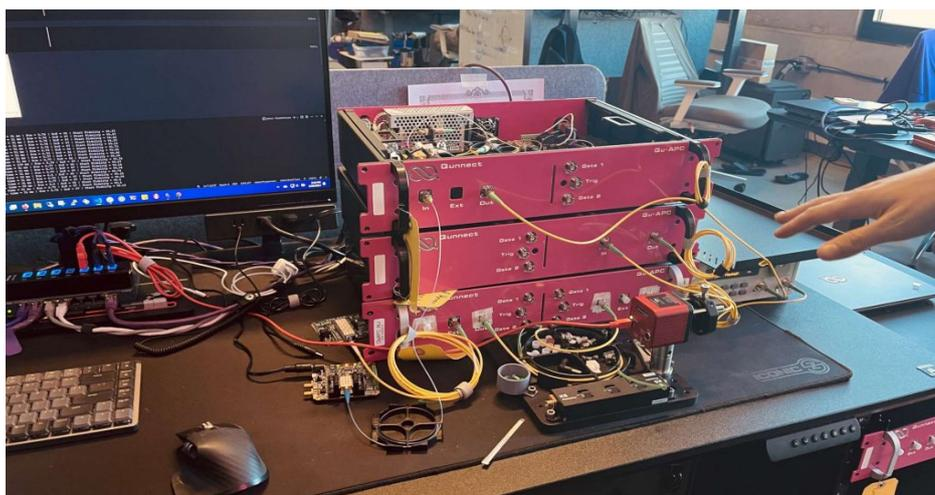
A noter que les mémoires quantiques à base d'atomes froids de Welinq nécessitent un refroidissement des atomes à basse température, réalisé avec des lasers dans des pièges magnéto-optiques (MOT), mais sans faire appel à de la cryogénie.
