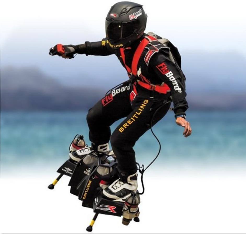
L'origine des deux types de turbines utilisées n'est pas précisée mais elle est commerciale. Le sourcing est peut-être le même que celui de Richard Browning qui n'est pas non plus précisé. Le système est pilotable par joystick avec ajustement dynamique de l'orientation des tuyères pour la gestion de l'équilibre.
