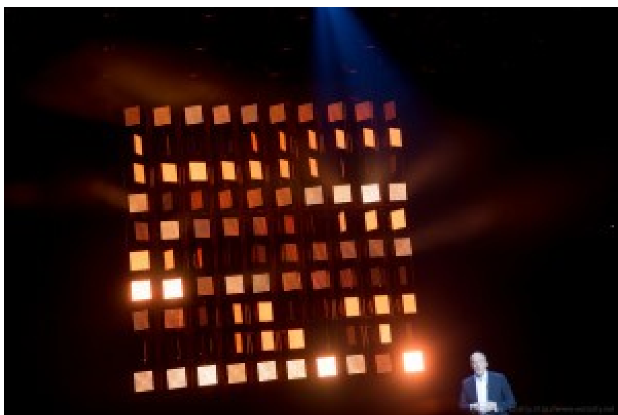
Les Dreampanel Twin ont un côté pile avec de grosses LED et un côté face avec de petites LED. Ces panneaux bifaces sont motorisés sur deux axes. Ingénieux !
