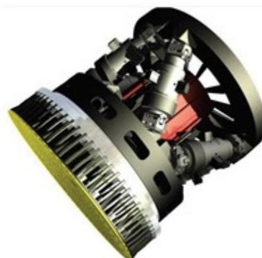
Les instruments qui récupèrent la lumière du télescope sont situés en dessous de celui-ci, dans la position dite grégorienne. Un troisième miroir, le M3, est orientable et envoie la lumière vers celui des instruments qui est utilisé. Un seul peut l'être à la fois.
