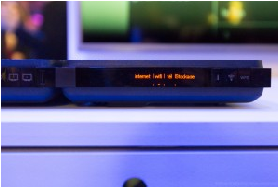
L'afficheur de la gateway indique ce qui fonctionne dans le réseau domestique. Mais seulement lorsque la présence d'un utilisateur est détectée à proximité de la box.
