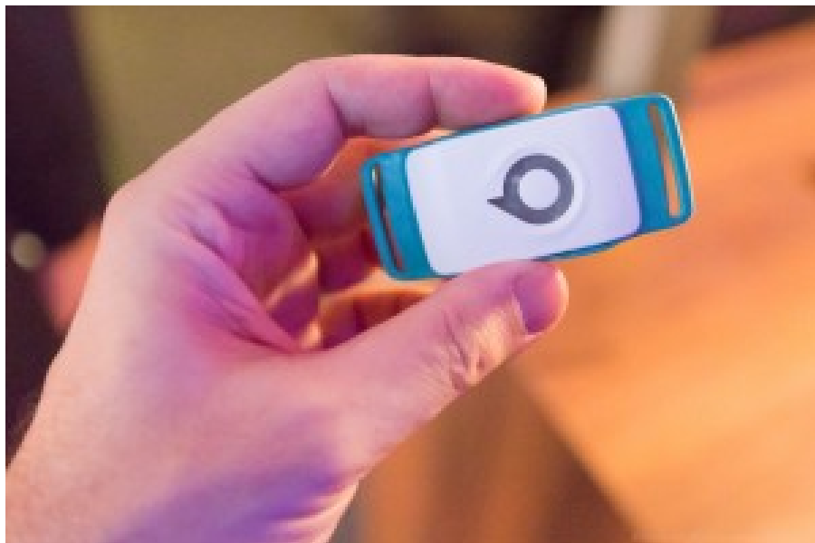
Le dongle d'Abeeway qui permet de géolocaliser des objets via le réseau LoRa.
