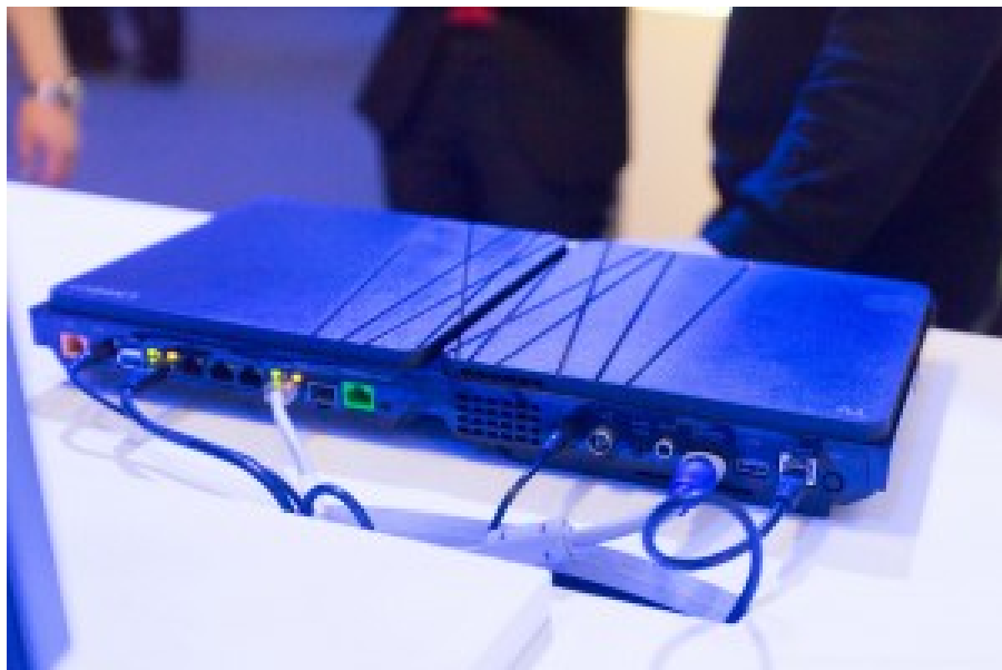
La connectique arrière des deux box est classique. Du Ethernet 1 Gbits/s pour la gateway, du HDMI 2.0 pour la box TV, etc. On note l'entrée antenne TNT dans la box TV !
