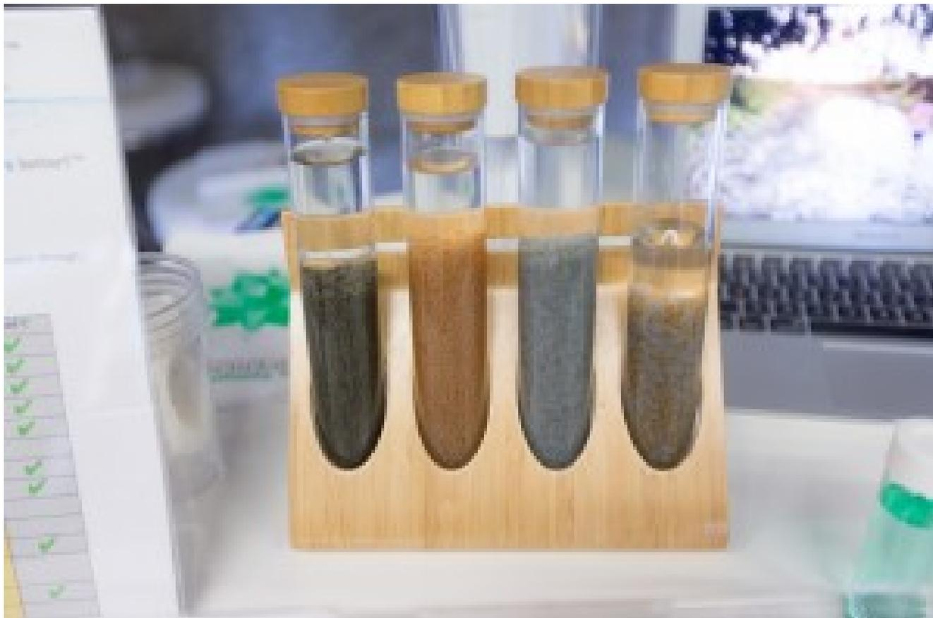
Les billes de Wavve à base de graphène servant à alimenter des filtres à eau potable plus efficaces.
