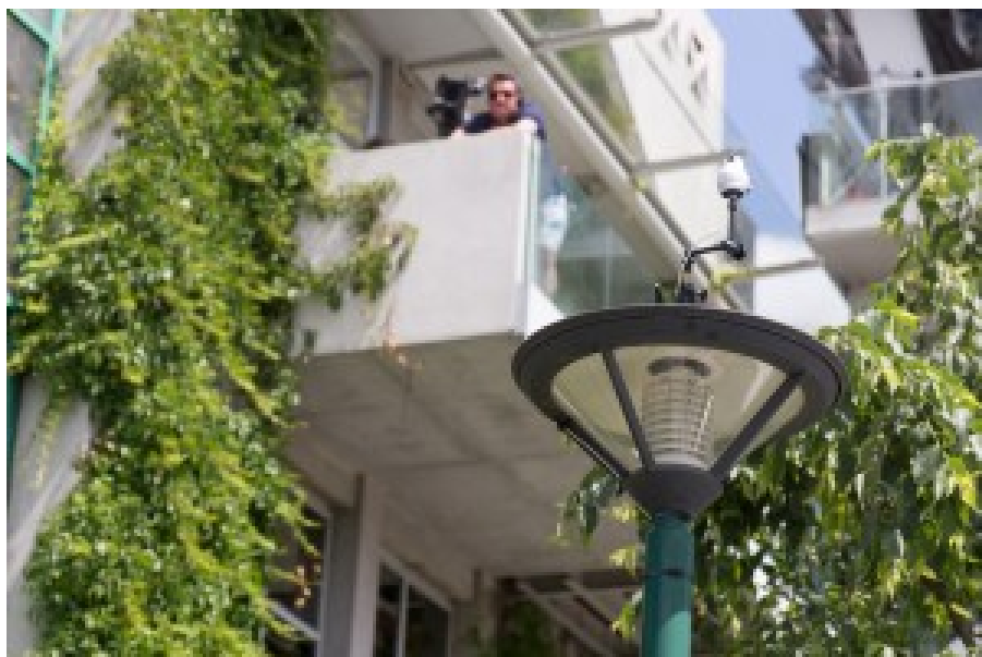
La caméra Giration posée sur un lampadaire et entourée de téflon blanc pour résister au climat breton
