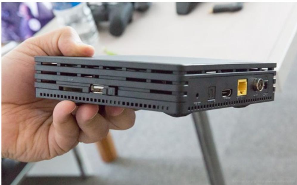
Ses entrées/sorties sont une prise RJ45 Ethernet, l'alimentation avec une alimentation externe en 12V, une prise HDMI, une prise audio optique, une prise coaxiale pour antenne TNT et une prise USB. Le design du boîtier est
