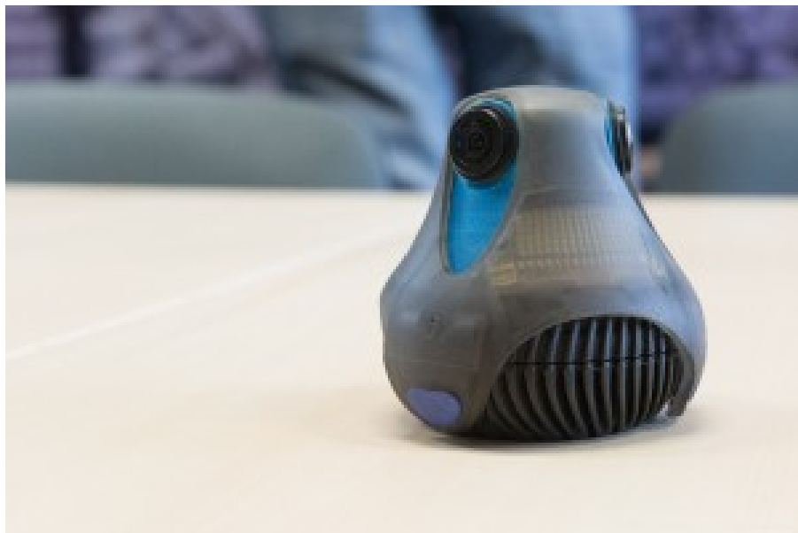
La caméra 360° de Gyroptic qui a réussi à lever $1,4m sur Kickstarter. Elle est dotée de trois capteurs fonctionnant chacun à 180° et d'une électronique embarquée assemblant ses trois images vidéo en temps réel.
