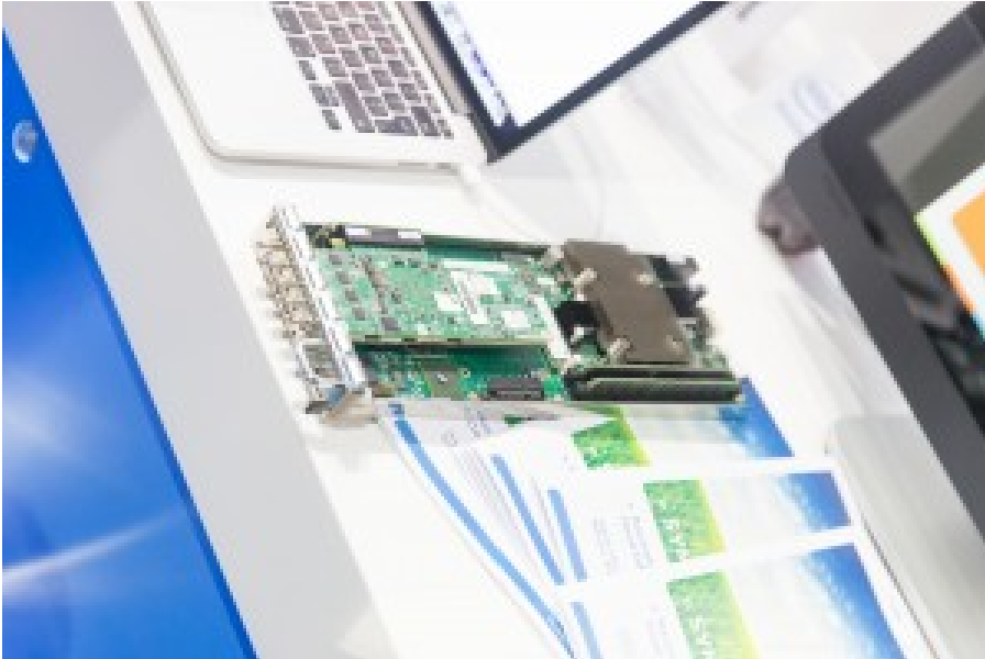
Serveur de streaming vidéo comprenant un processeur Core i7 et 8 entrée coaxiales SDI pour streamer huit chaînes TV en parallèle. Un rack 2U intégrant deux switches et ces serveurs permet le streaming de 128 chaînes en simultané. Le serveur est de l'allemand Kontron et le logiciel de gestion de diffusion de la vidéo provient du canadien Vantrix.
