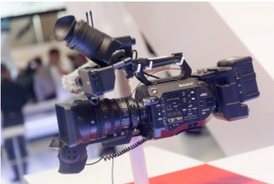
A l'IBC, Sony présentait sa nouvelle caméra PXW-FS7 qui vient enrichir une gamme étendue de caméras 4K. Celle-ci est de format "reportage" et est dotée d'un grand capteur Super 35 mm.
