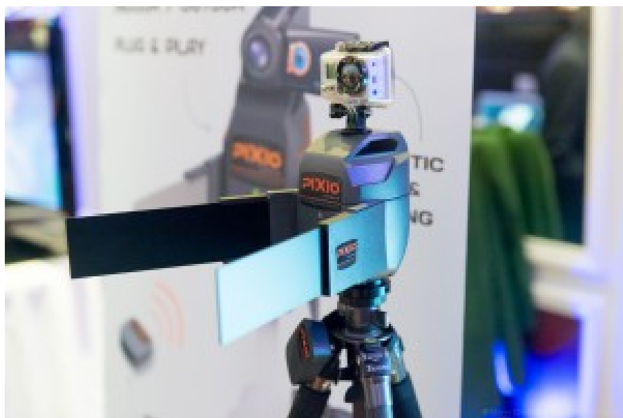
Le support de caméra robotisé Pixio de Move'n See qui complète la gamme existante avec un prix inférieur à 1000€ et la capacité à fonctionner en intérieur. Le sportif porte un capteur sur lui connecté en bande radio sub-GHz avec le support robotisé de caméra, qui le suit au gré de ses mouvements. Les ailes sur le côté sont des antennes radio.
