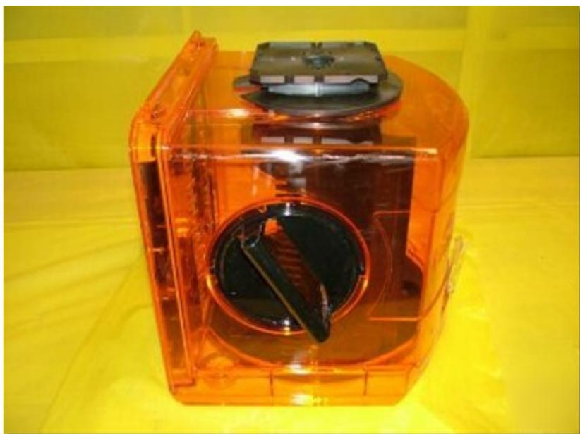
Ces pods circulent dans la fab grâce à des convoyeurs robotisés situés au plafond et installés en 2007. Ils posent les boîtes de plaquettes (wafers) sur les machines grâce à un système de support vertical qui se déploie sur cinq mètres de hauteur. La circulation des lots de production est automatisée comme dans toutes les lignes de fab avancées dans le monde. Auparavant, les wafers circulaient sur des robots roulant à même le sol mais nécessitaient une manipulation avec des opérateurs.
