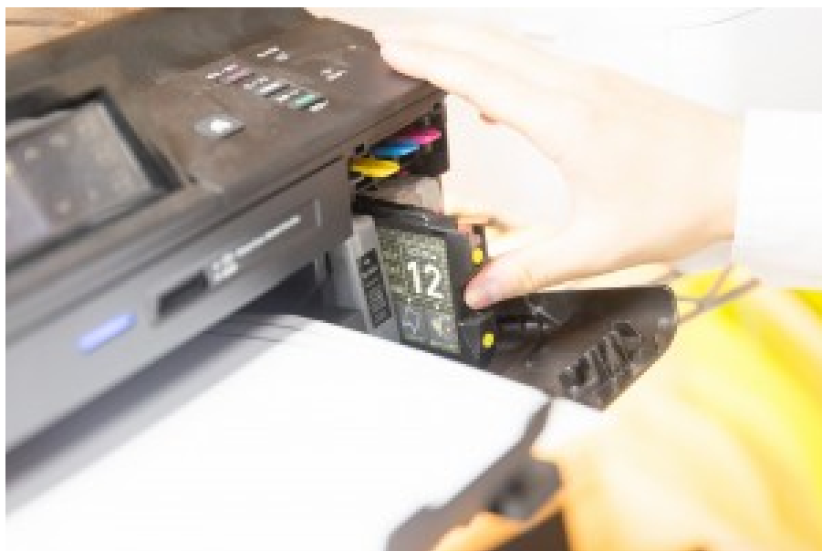
L'encre électronique d'AgIC est fournie sous la forme d'une cartouche d'encre pour imprimantes à jet d'encre japonaises (Brother, Canon, Epson). Elle existe aussi sous forme de stylo.
