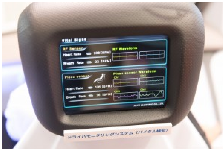
Démonstrateur de rendu de capteurs biométriques intégrés dans le siège conducteur chez Alps. Pour capter pouls et rythme respiratoire et détecter des anomalies.
