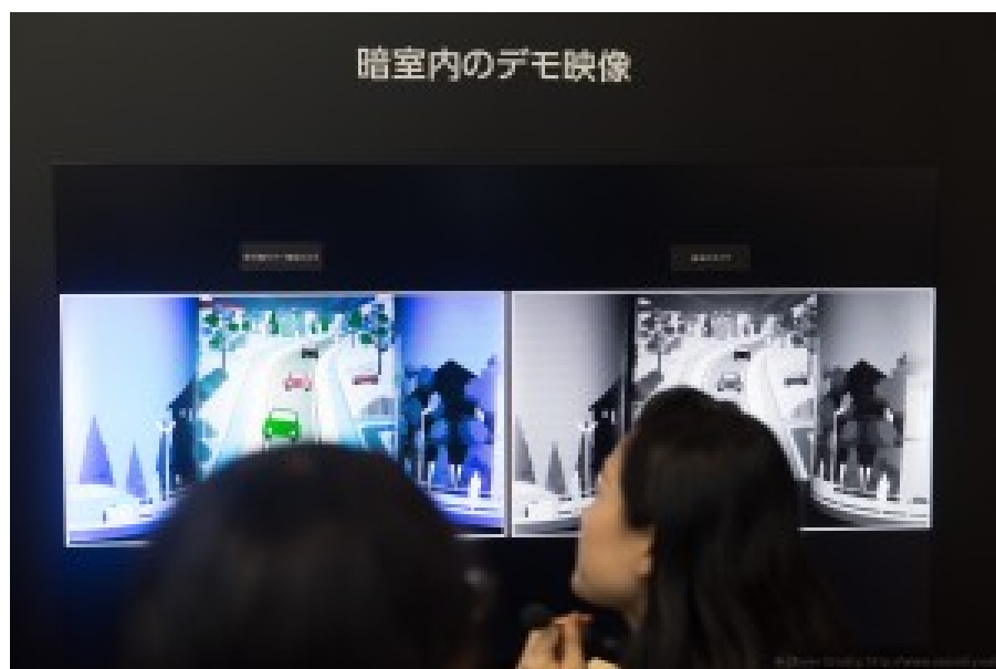
Démonstration de vision nocturne en couleur chez Sharp avec une caméra infrarouge. A gauche son rendu et à droite le rendu d'une caméra infrarouge classique. Reste à comprendre comment cela
