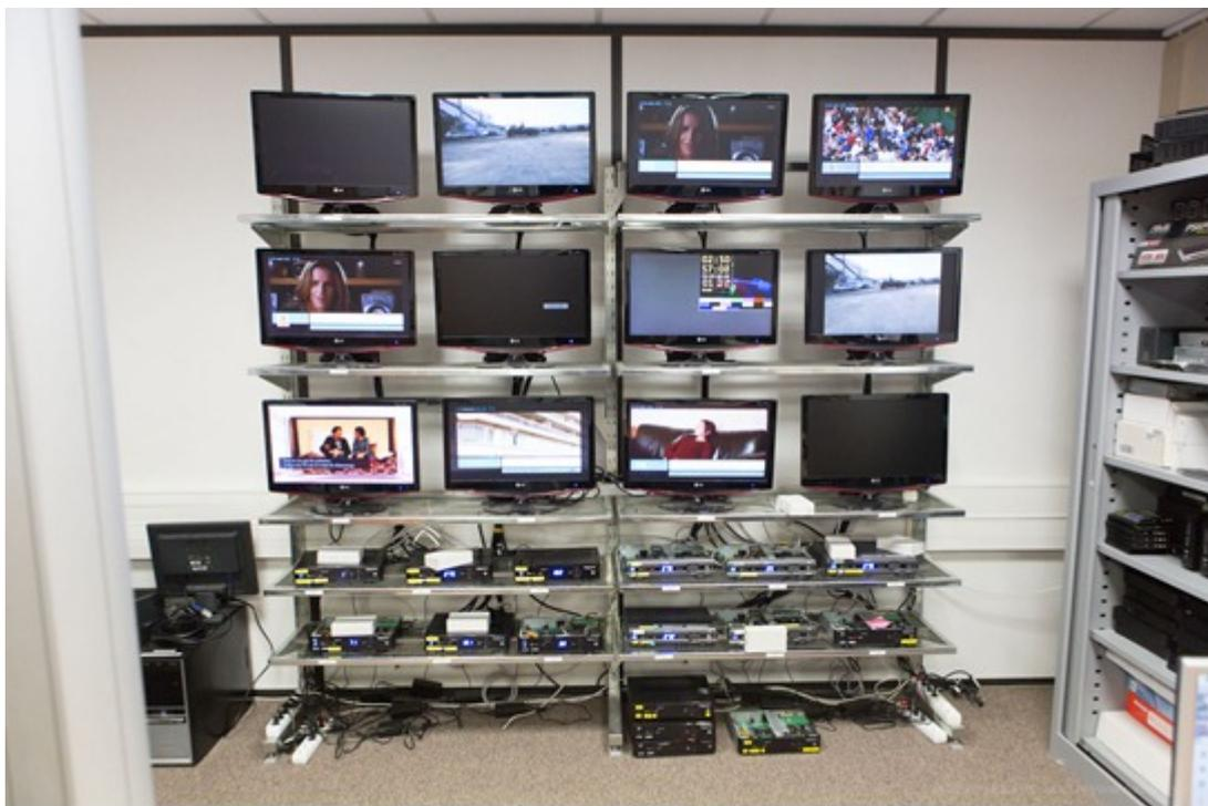
Les bancs de tests utilisent des logiciels de simulation de télécommande (*ci-dessous*).
