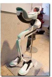
• Le Bodyweight Supporting Walking Assist Device (*ci-dessus à droite*), un petit exosquelette pour les jambes qui aide à marcher mais pas au point d'être adapté aux handicapés. Au passage, les robots humanoïdes ne sont plus de la partie! Les industriels japonais essayent de faire des choses qui marchent, au sens propre comme figuré!
