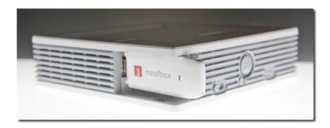
SFR propose une extension "Femtocell" additionnelle, un boitier qui se rajoute au modem en se glissant dessus, sachant que la connectique est une simple prise USB. L'option est payante, à 199€. Elle permet d'obtenir une meilleure couverture 3G à domicile. Elle sert surtout à réduire les couts d'infrastructure pour l'opérateur! L'extension existe toutefois dans un autre packaging utilisable pour les clients de mobiles de SFR qui ont un autre FAI que SFR.
