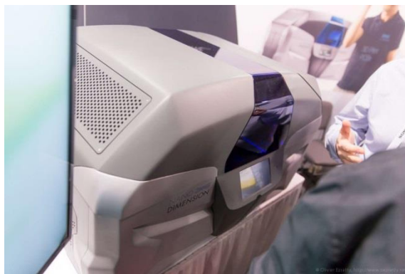
L'imprimante 3D de l'israélien NanoDimension produit des circuits imprimés multi-couches.
