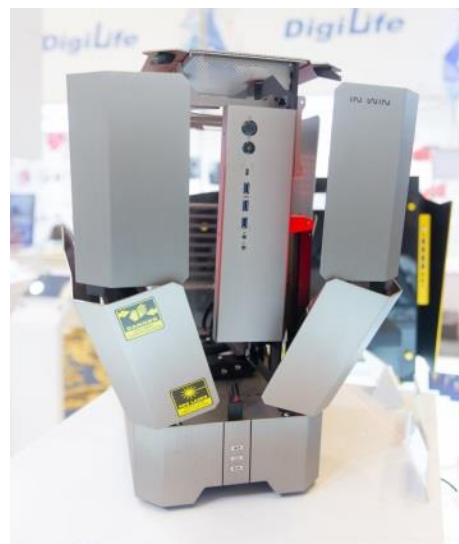
L'étonnant boîtier « transformer » motorisé de PC du taiwanais In Win .
