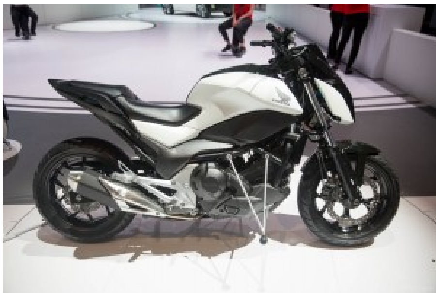
La moto gyrostabilisée de Honda. Elle reste debout à l'arrêt. Sauf ici, sur le stand.
