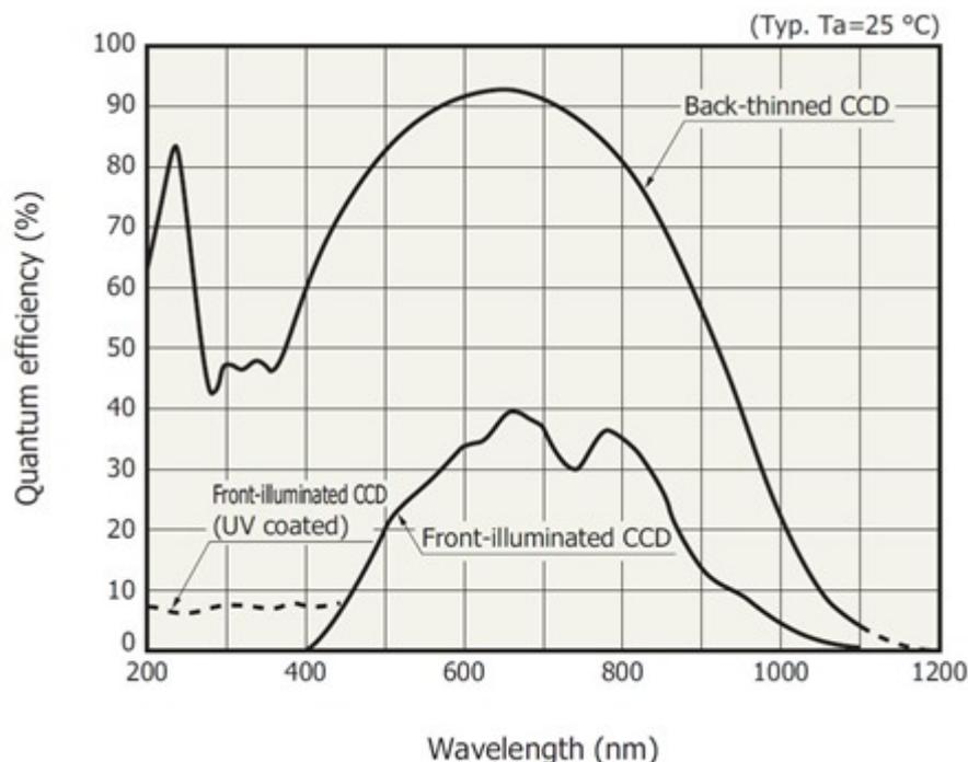
Les capteurs CCD sont aussi passés au rétro-éclairage, avec une électronique analogique de récupération du signal située derrière le composant au lieu d'être du côté de la réception de la lumière. C'est une technique courante en photo grand public avec les capteurs CMOS-BSI que l'on trouve notamment chez Sony. Avec le rétroéclairage, l'efficacité quantique s'approche des 100%. Aujourd'hui, la grande majorité des CCD utilisée en astronomie est rétro-éclairée.
