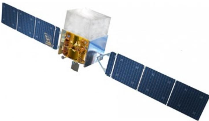
Le **Large Area Telescope (LAT)** est doté d'un très grand champ de vue de  $5^\circ$  qui lui permet de couvrir tout le ciel toutes les deux orbites. Les rayons gamma qui entrent dans le LAT sont convertis en particules dont l'énergie et la directivité sont alors mesurées. Il capte les rayons gamma d'énergie très élevée, comprise entre 20 MeV et 300 GeV. C'est le seul télescope spatial atteignant ce niveau.
