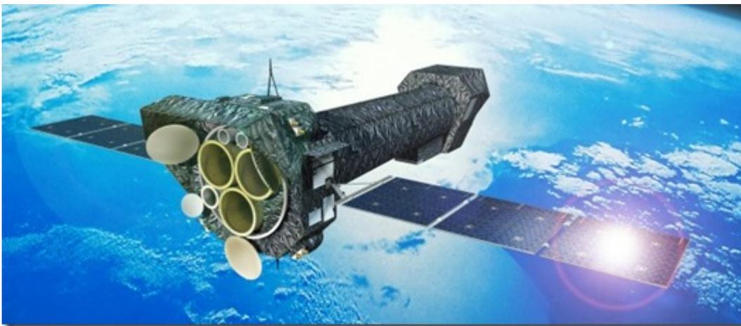
Le télescope fait 10,8 m de long et une envergure de 16,16 m avec ses panneaux solaires déployés. Il pesait 3764 kg au lancement. Il est orientable dans toutes les directions pour gérer ses observations avec une précision de 0,25 arcsecondes, à la vitesse d'escargot de 90° par heure. Il communique avec la Terre en bande S. Les sources des illustrations sont dans le **XMM-Newton Users Handbook**.
