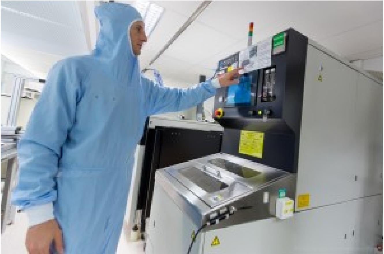
L'une des machine de polissage de wafers qui va diminuer leur épaisseur pour s'adapter au packaging du produit final.
