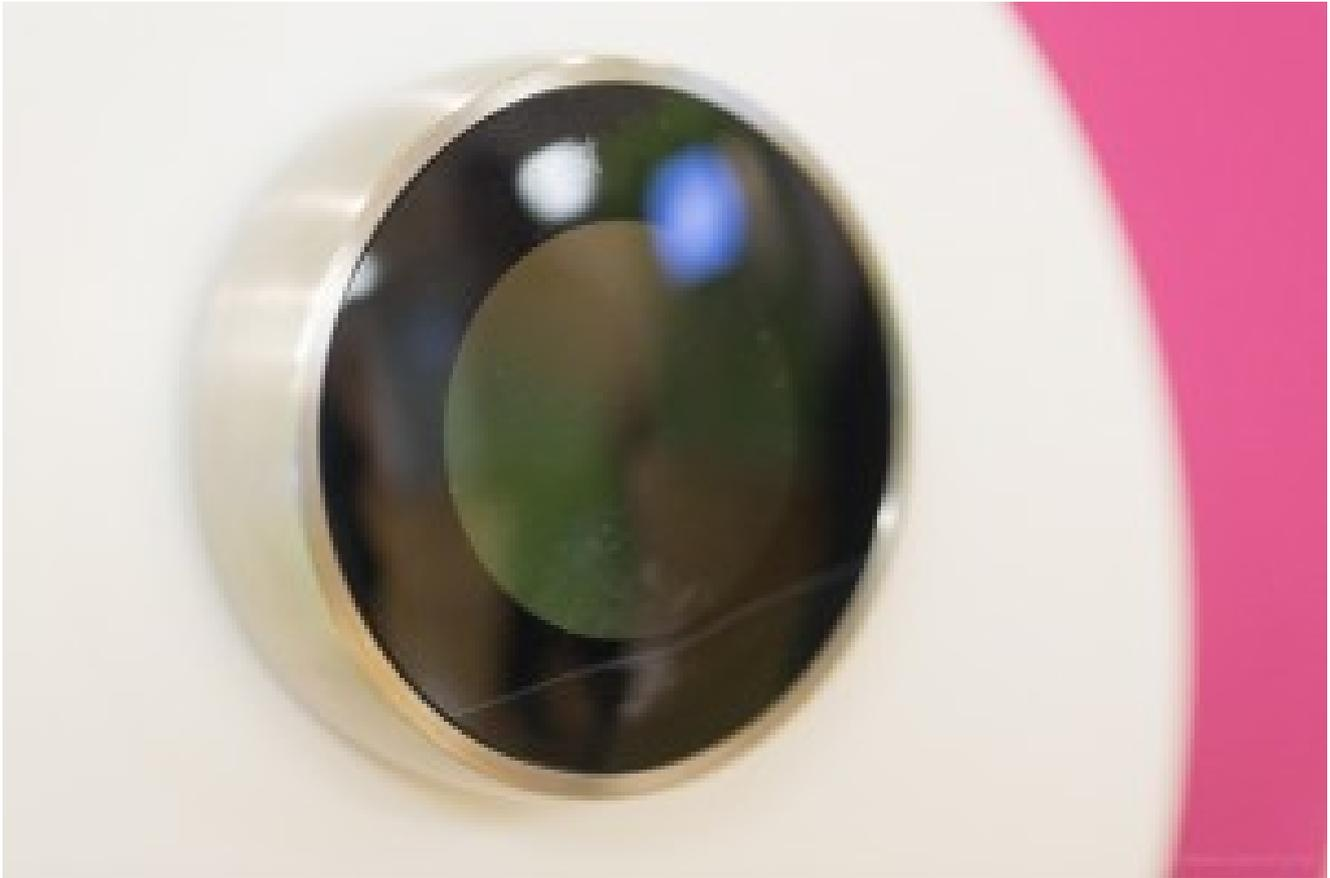
Un thermostat Nest qui comprend un micro-contrôleur 32 bits STMicroelectronics ARM Cortex-M3.
