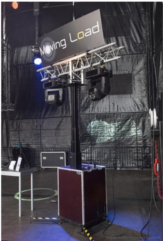
Arrivé dans le salon, je tombe sur une autre PME française, **StageMaker**, qui propose son nouveau système palan (levage à chaîne), le SRS. Il se distingue par une double innovation mécanique, le Perfect Push et le Flex Push, qui facilitent la circulation de la chaîne dans le palan et évite notamment son blocage. La PME est spécialisée dans le levage industriel et le matériel de scène. Elle fait 60m€ de CA et 50% à l'international, ce qui est pas mal !
