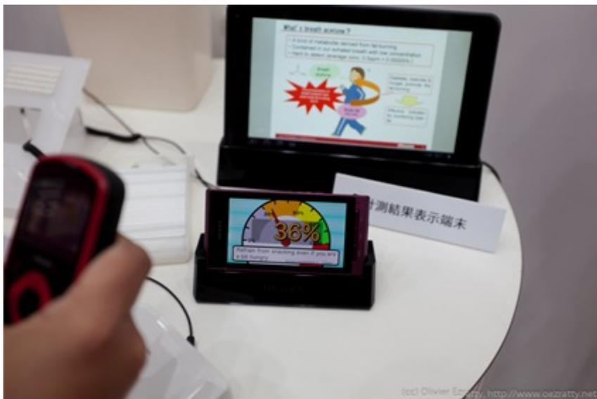
Un **capteur de masse graisseuse**, que l'on trouve habituellement dans les balances, mais qui prend la forme d'une coque pour smartphones avec deux électrodes. Il a l'air d'utiliser un composant vu chez Murata.
